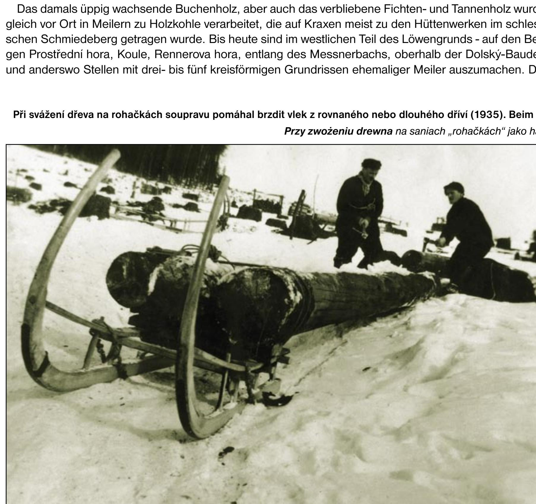
Při svázení dřeva na rohačkách soupravu pomáhal brzdit vlek z rovnáho nebo dlouhého dříví (1935). Beim Transport des Holzes auf Hörnerschlitten wurde die Bremswirkung des gezogenen gestapelten oder Langholzes genutzt. (1935).
